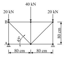
Considerando a figura precedente, que ilustra o esquema de uma treliça isostática composta por montantes verticais e banzos horizontais e diagonais que formam 45° com as peças adjacentes, julgue o item a seguir, desprezando as resistências das articulações e o peso próprio da estrutura.
