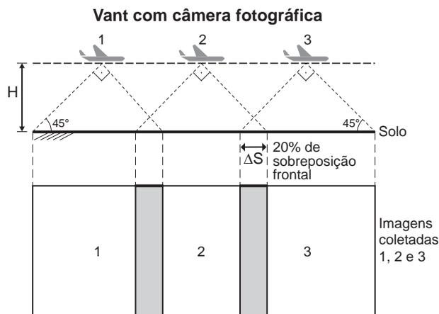
O operador do vant recebe uma encomenda na qual as imagens devem ter uma sobreposição frontal de  $20\%$  em um terreno plano. Para realizar a aquisição das imagens, seleciona uma altitude  $H$  fixa de voo de  $1\ 000 \text{ m}$ , a uma velocidade constante de  $50 \text{ m s}^{-1}$ . A abertura da câmera fotográfica do vant é de  $90^\circ$ . Considere  $\text{tg}(45^\circ) = 1$ .
