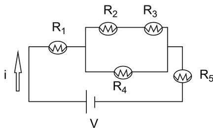
Durante o experimento, o resistor  $R_3$  queima, e, como resultado da medida da intensidade da corrente elétrica que atravessa o resistor  $R_1$ , foi obtido valor igual a 4 A.
