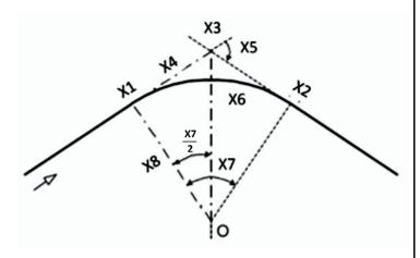
No projeto geométrico de uma via, para a concordância de dois alinhamentos retos que se interceptem em um vértice, utiliza-se, geralmente, a curva circular. Na figura acima, está representado o esquema de uma concordância com curva circular simples. Sendo assim, assinale a alternativa que apresenta os elementos técnicos característicos da curva circular simples correspondentes aos X enumerados.
