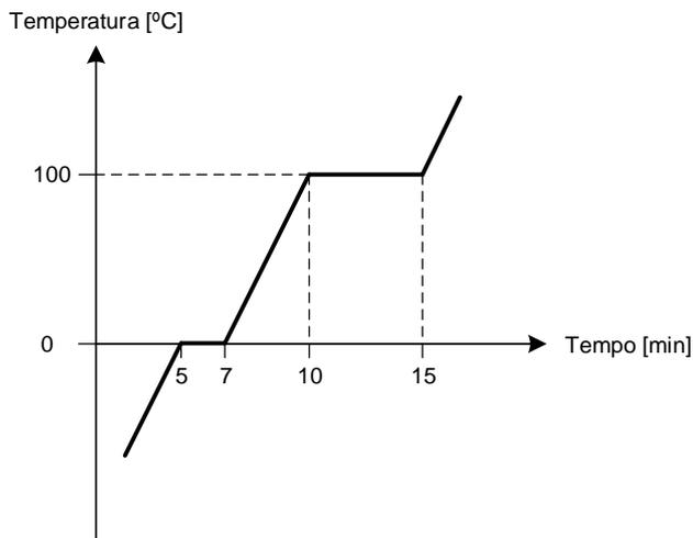
O equipamento responsável pelo aquecimento da substância fornece uma potência constante de 500 W durante todo o processo.
