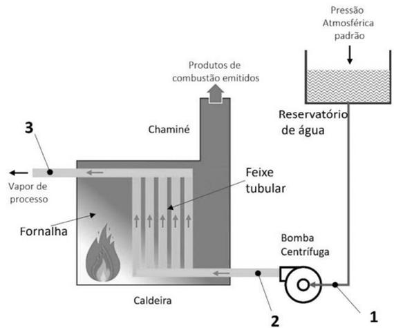
O diagrama precedente representa uma unidade geradora de vapor instalada ao nível do mar. Nos pontos 1 e 2, a temperatura da água, cuja densidade é igual a  $1.000 \text{ kg/cm}^3$ , é igual a  $25 \text{ }^\circ\text{C}$ , a elevação de pressão causada pela bomba é de  $74 \text{ kPa}$ , a temperatura no ponto 3 é igual a  $133 \text{ }^\circ\text{C}$ , e o reservatório de água é mantido aberto e cheio, tendo sido instalado a  $5 \text{ m}$  de altura do ponto de sucção da bomba centrífuga.
