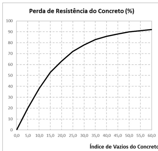
Determinada peça de concreto requer uma resistência à compressão ( $f_{ck}$ ) de 10MPa, considerando um índice de vazios nulo.
