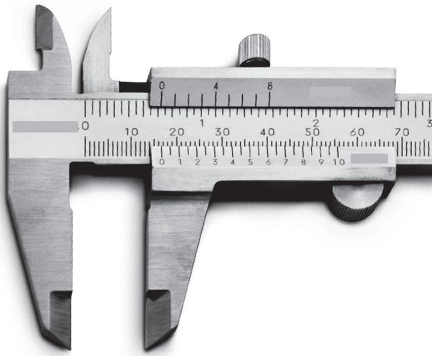
Em uma situação hipotética, precisa-se medir uma peça com diâmetro externo de 10,47 mm (+/- 0,01 mm), tendo-se disponível um paquímetro universal analógico com intervalo de indicação (escala fixa inferior) 0-100 mm e com as escalas fixa e móvel (vernier ou nônio), como mostrado na Figura.
